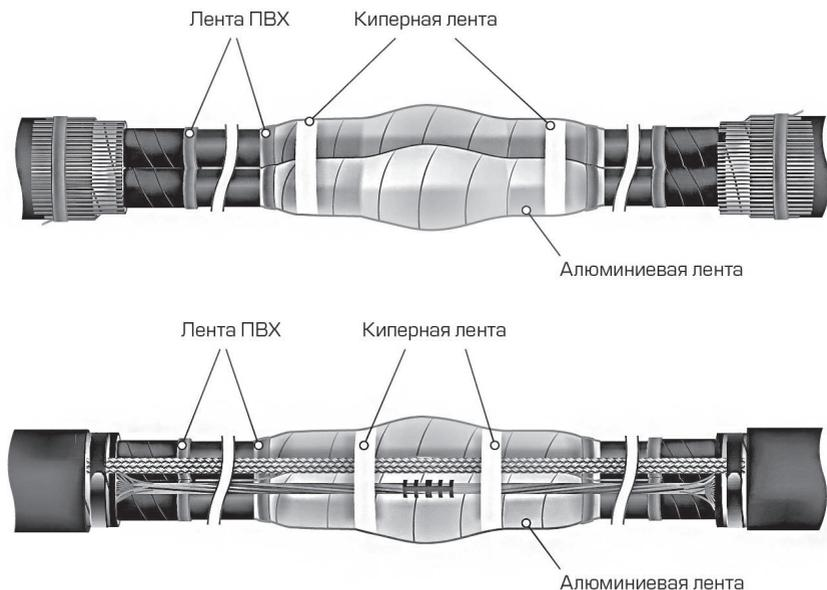
**8.1** Произвести обмотку каждой жилы алюминиевой экранирующей лентой с перехлестом витков 20-30 мм и заходом на полупроводящий слой жил на 15-20 мм.
