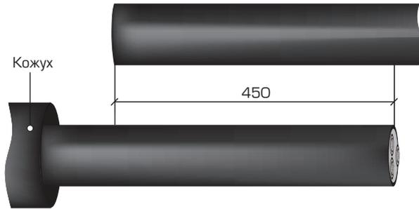
**1.1** Распрямить один конец кабеля на длине 2000 мм, другой — 1500 мм, очистить их от загрязнений и расположить их друг напротив друга с перехлестом в 450 мм.
