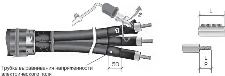
Трубка выравнивания напряженности электрического поля
