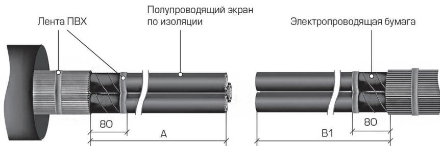
**2.2** Медную бандажную ленту, фиксирующую проволочный экран, обрезать на уровне среза внешней оболочки. На месте среза ленты не должно оставаться острых выступающих кромок. Расплести медные проволоки экрана каждой жилы обоих концов кабеля; без натяга отогнуть их на наружную оболочку кабеля и с помощью изоляционной ленты ПВХ временно закрепить на наружной оболочке кабеля.
