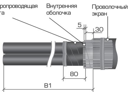
**3.2** На расстоянии 30 мм от среза наружной оболочки обоих концов кабеля специальным инструментом сделать кольцевые надрезы на бронелентах и снять броню. На расстоянии 5 мм от среза бронелент, сделать кольцевой надрез на внутренней оболочке кабеля и удалить внутреннюю оболочку и межфазный наполнитель.
