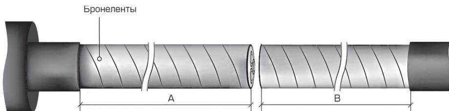
**3.1** Удалить с кабеля наружную оболочку согласно рисунку и таблице (разделка на размер А должна проводиться со стороны кабеля с надетым кожухом).
